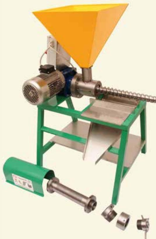
Le spremiatrici “**BIO 100**” sono state progettate e costruite per la lavorazione dei semi oleaginosi permettendo di ottenere olio da destinare alla produzione di bio-diesel, e pannello proteico sotto forma di pellet.
